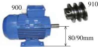
900. Elmotor. Vid mått 80mm - axel/motorfot måste distansbrickorna under motorfoten monteras. Vid mått 90mm får distansbrickorna ej monteras. 910. Remskiva - A62 f.o.m. chassienr. 1100.
