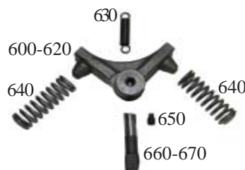
600-620. Vinkelspär - axeldiameter 20mm upp till chassienr. 737. 610. Vinkelspär - axeldiameter 22mm upp till chassienr. 1508. 620. Vinkelspär - axeldiameter 26mm från chassienr. 1509 -
