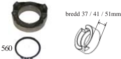
530. Medbringare - bredd 37mm upp till chassienr. 664. 540. Medbringare - bredd 41mm upp till chassienr. 2184. 550. Medbringare - bredd 51mm från chassienr. 2185. 560. Segersäkring.
